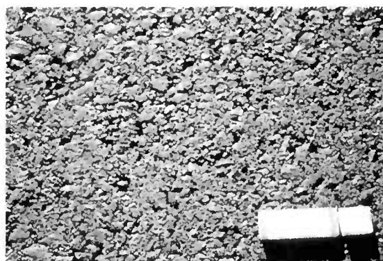
Béton bitumineux semi-grenu (0/14)
